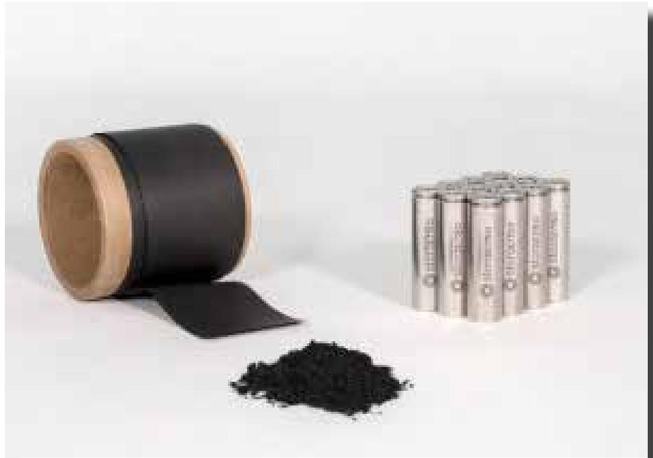
Lignodepulver, daraus hergestellte Anodenfolie und fertige Batterien © [storaenso.com/en](http://storaenso.com/en)
