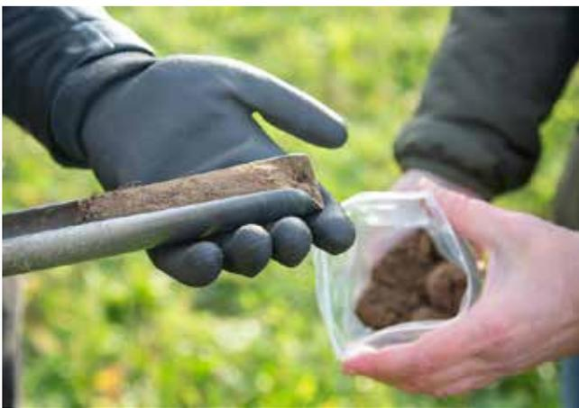
Bodenprobenahme mittels Bohrstock. © Julia Tetzke, Universität Rostock
